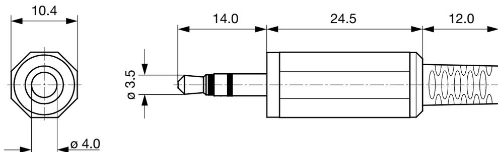
Kabeldurchmesser max. 4.0 mm
